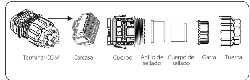
b) Seleccione un conductor de 0,5-0,75 mm<sup>2</sup> y utilice un pelacables para pelar la capa de aislamiento de 12-14 mm del extremo del cable e inserte el terminal aislado del cable en el extremo del mismo. (ENY0512 terminal de nylon para conductor de 0,5 mm<sup>2</sup>/22 AWG; ENY7512 terminal de nylon para conductor de 0,75 mm<sup>2</sup>/20 AWG)
