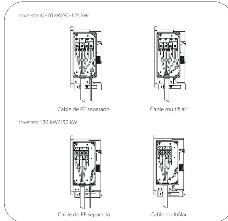
b) vuelva a instalar la tapa de la caja de cableado y apriétela (con un par de apriete de 5-7 Nm).
