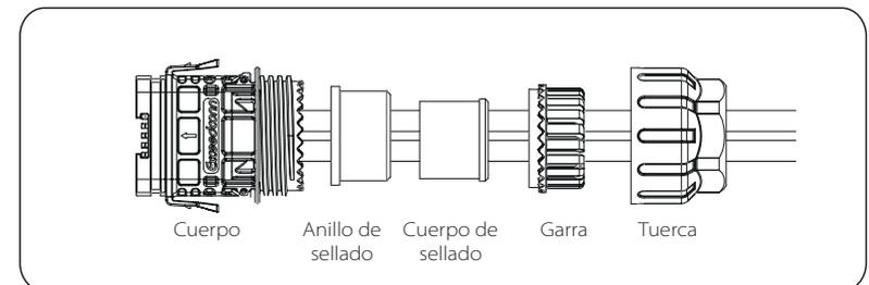
e) Inserte el terminal tipo tubo en la carcasa según la etiqueta colocada en él. Empuje la carcasa con el terminal insertado dentro del cuerpo. Se producirá un ligero sonido de "click", que indica que la conexión se ha completado.
