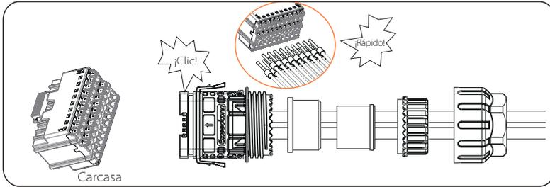
f) Empuje el cuerpo de la junta en el anillo de la junta y luego empuje la garra.
