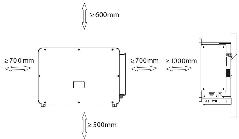
Para la instalación de varios inversores, reserve un espacio de 1200 mm como mínimo entre cada inversor izquierdo y derecho y de 500 mm como mínimo entre cada inversor superior e inferior.
